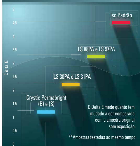
Mudança de Cor de Gelcoats Brancos depois de 12 meses de exposição na Flórida (Delta E)**
