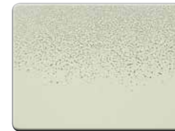
Gelcoat Abrindo (Pistola)
