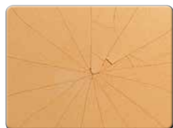
Trincas Em Estrela
